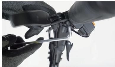
Réglez la position du frein et serrez les boulons de fixation à l'aide d'une clé hexagonale de 5 mm.
