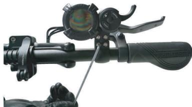
Placez le tableau de bord et serrez les vis de fixation.
